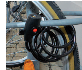
Die dünnen Innendrähte des Spiralseilschlösses sind mit einem Seitenschneider durchtrennbar.
