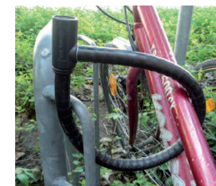
Der Schein trägt: Außen scheinbar stabil, innen nur ein dünnes Seil.
