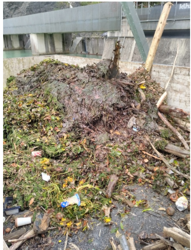
Abbildung 42: Rechengut – Kraftwerk Hochwuhr (Quelle: © Stadtwerke Feldkirch/Hans-Jörg Mathis)
