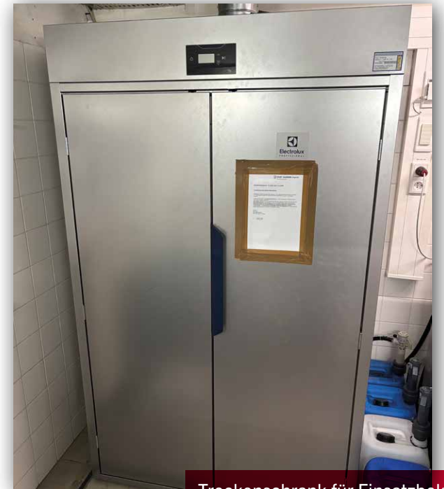
Trockenschrank für Einsatzbekleidung
