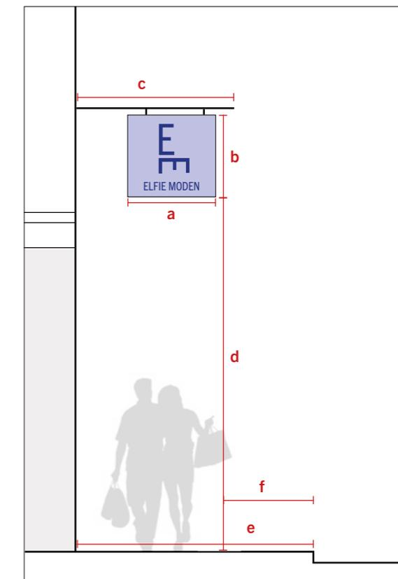
Alle relevanten Abmessungen (a, b, c, d – Breite, Länge, Höhe) sind maßstabsgetreu im Plan einzutragen. Es muss in der Plandarstellung und im Lageplan ersichtlich sein, wo die Werbemaßnahmen an der Fassade angebracht sind.
