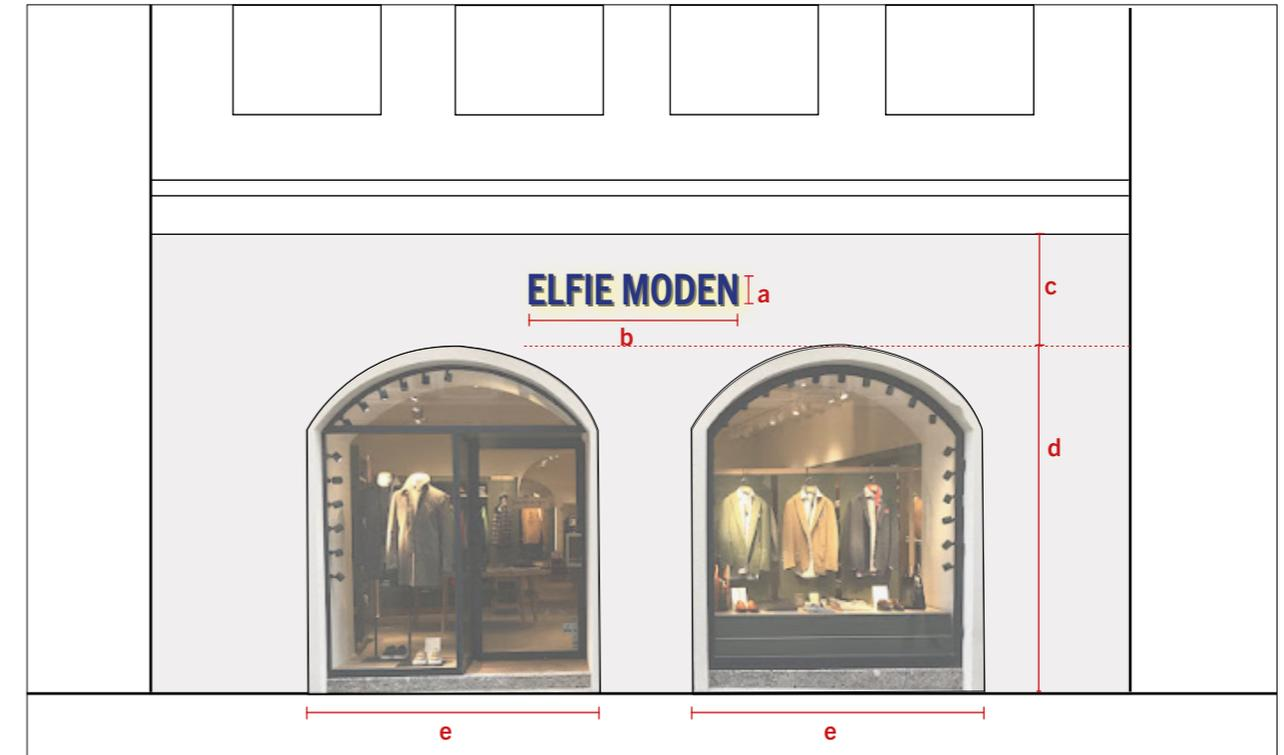
Alle relevanten Abmessungen (a, b, c, d – Breite, Länge, Höhe) sind maßstabsgetreu im Plan einzutragen. Es muss in der Plandarstellung und im Lageplan ersichtlich sein, wo die Werbemaßnahmen an der Fassade angebracht sind.
